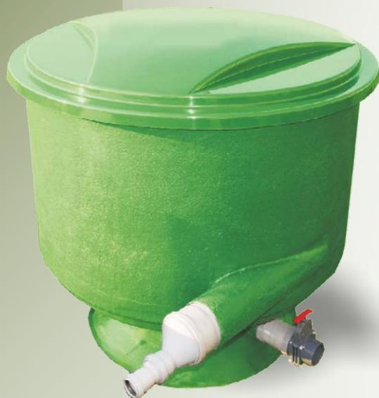
Filtr mechaniczny pasujący do BIOklar 120 i 140, a po częściowym wkopaniu w ziemię, także do mniejszych filtrów z serii BIOklar. Woda wpadająca do komory filtra wprawiana jest w ruch wirowy, dzięki czemu wszystkie zanieczyszczenia zatrzymują się w odstojniku, z którego okresowo należy je usuwać, poprzez otwarcie zaworu opróżniającego zbiornik. Filtr Vortex wykonany jest z bardzo trwałego laminatu poliestrowego.
